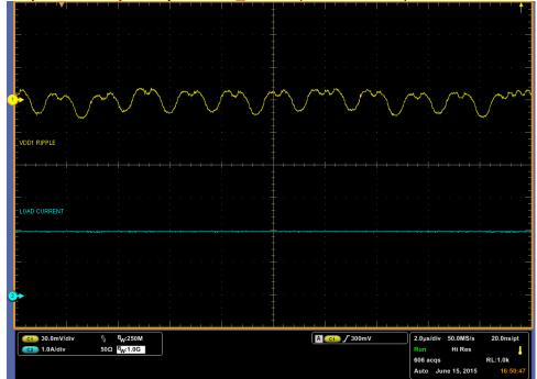
VDD1 (Vin=5V, Vout=1.5V, PWM) - NVCC\_DRAM (2000mA Load)
