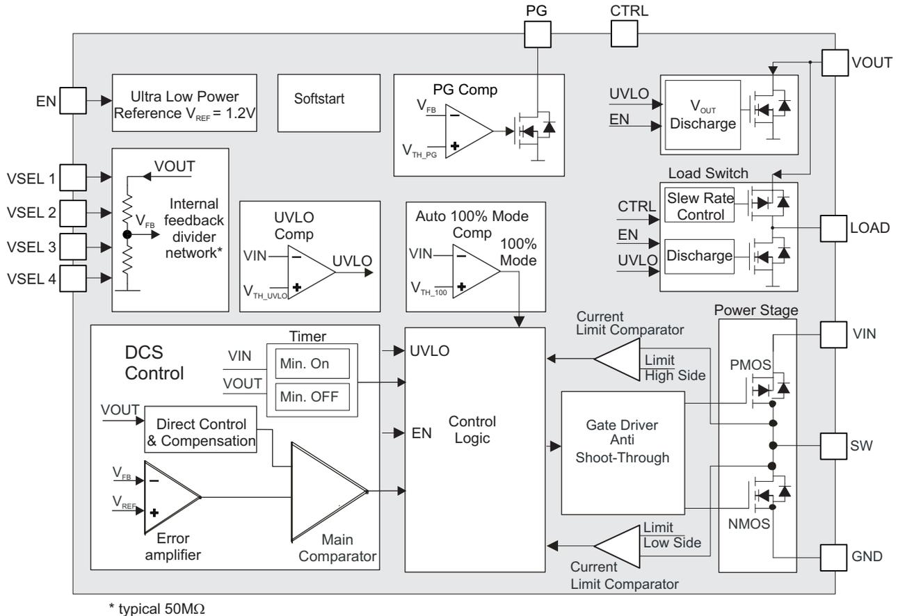
**Figure 1. TPS62740 Block Diagram**
