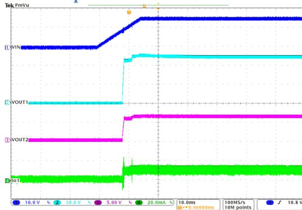
$V_{IN}=15\text{V}$ ,  $I_1=0$ ;  $I_2=0$ ;  $I_3=10\text{mA}$
