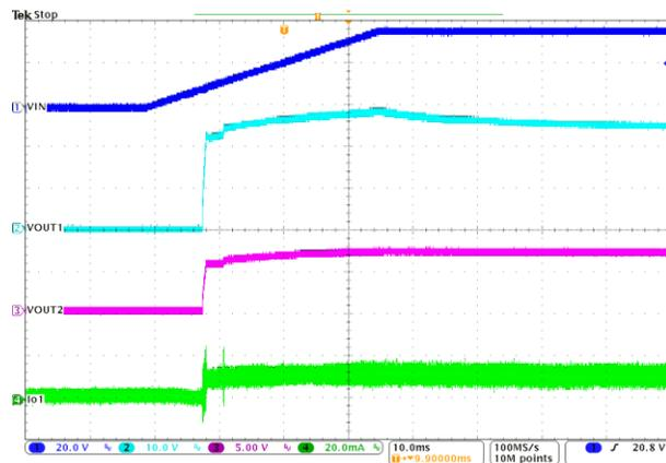
$V_{IN}=36\text{V}$ ,  $I_1=0$ ;  $I_2=0$ ;  $I_3=10\text{mA}$
