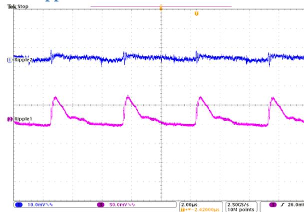
$V_{IN}=15V, I_1=0; I_2=0; I_3=50mA$
