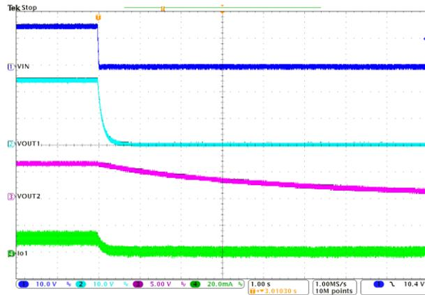
$V_{IN}=15V, I_1=0; I_2=0; I_3=10mA$
