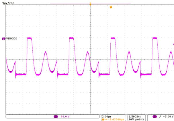
$V_{IN}=15V, I_1=0; I_2=0; I_3=50mA$
