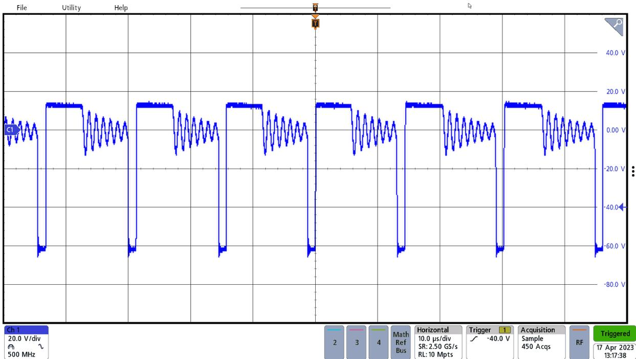
**Figure 3-6. Anode of Rectifier D4 – 265-VAC, 50-Hz Input, 12-V, 1-A Output**
