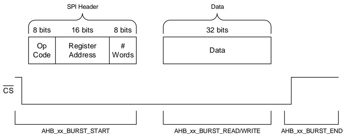
**Figure 20. SPI Packet Breakdown**
