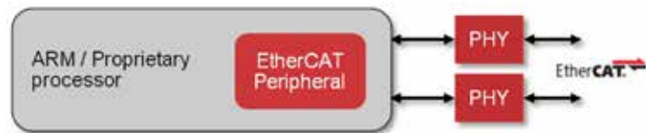
図6. プロセッサに内蔵されたEtherCAT
