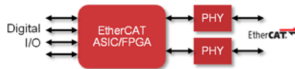
図4. 基本的なデジタルI/O EtherCATデバイス
