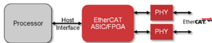
図5. ASICと外部プロセッサを備えたEtherCAT
