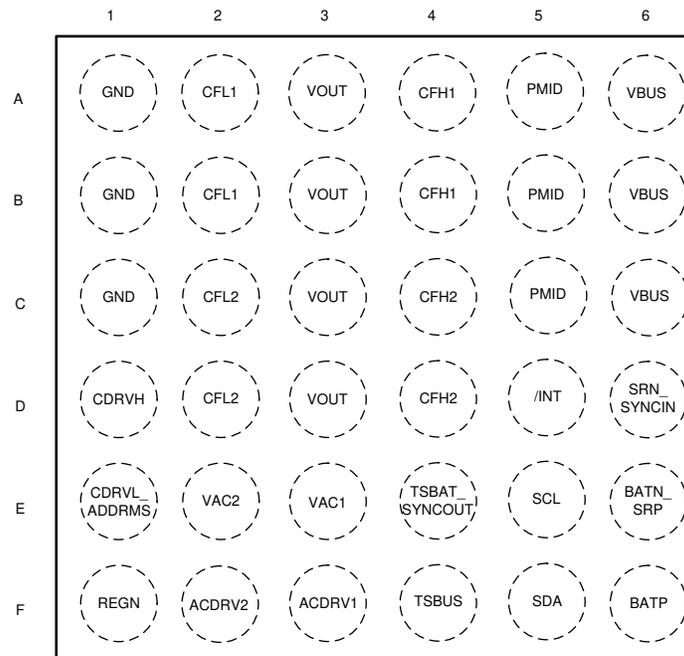
**Figure 6-1. YBG Package - BQ25960H 36-Pin DSBGA Top View**
