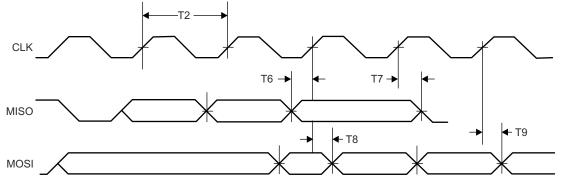
Figure 8-9. Host SPI Timing
