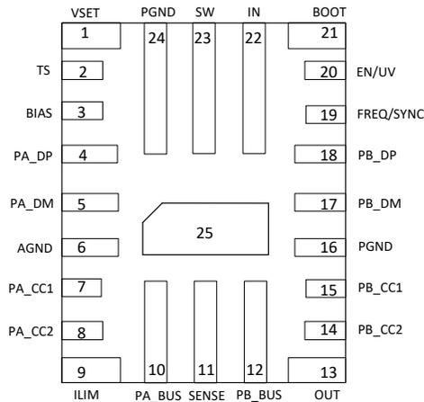
**Figure 7-1. TPS25858-Q1 RPQ Package 25-Pin (QFN) Top View**
