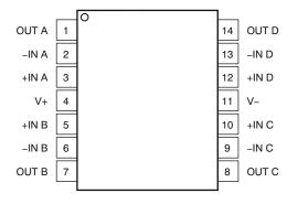
Figure 4-1. Pin Diagram
