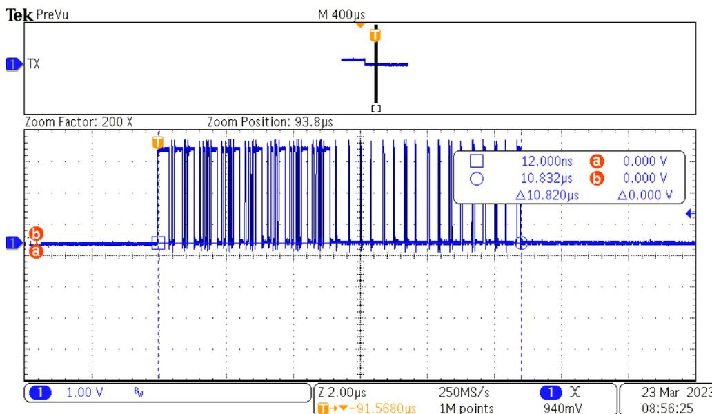
Figure 3-1. 64 Bytes Transmit Time
