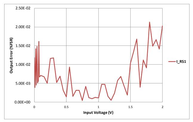
Figure 11. I<sub>RS1\_ERROR</sub> (%FSR) versus V<sub>IN</sub>
