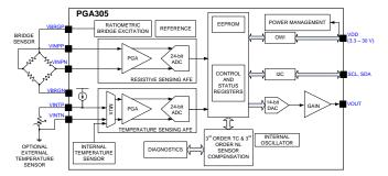
Figure 5. PGA305 Block Diagram
