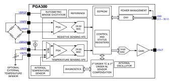
Figure 4. PGA300 Block Diagram
