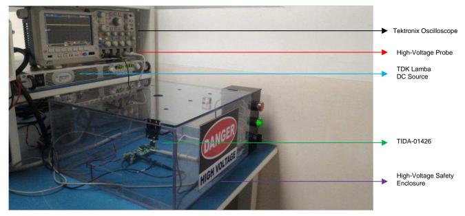
Figure 28. Test Setup
