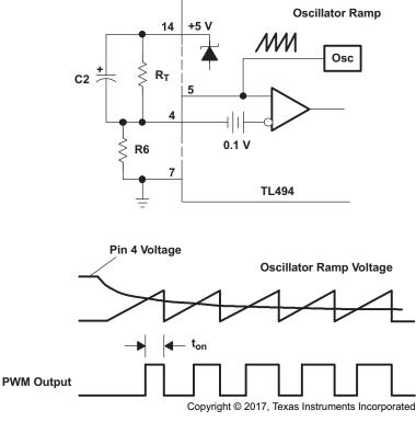
Figure 9. Soft-Start Circuit
