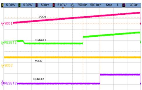
Figure 23. Power Sequencing: VDD2 Coming Before VDD1
